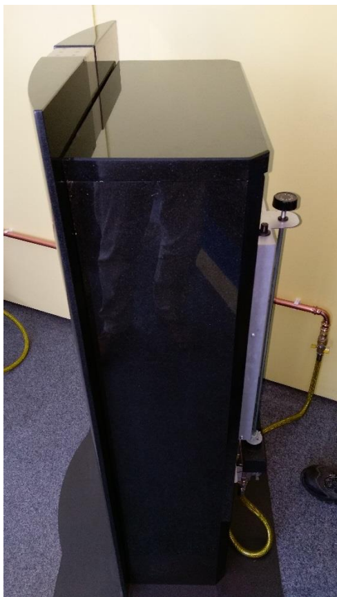
Pohled na sestavené topidlo a usazení kamenného obložení.
