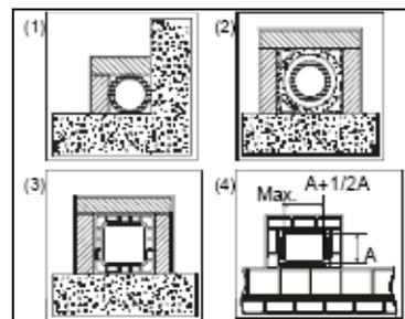
(1) Ocelový kouřovod AISI 316 s dvojitou komorou izolovanou materiálem odolávajícím teplotě 400 °C. **Výborná účinnost 100 %.**
