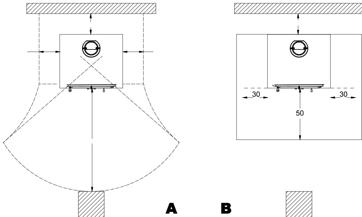
Všechny minimální bezpečné vzdálenosti (cm) jsou uvedeny na typovém štítku výrobku a NESMÍ se klesnout pod stanovené hodnoty (viz PROHLÁŠENÍ O VÝKONU - INFORMACE OZNAČENÍ CE).
