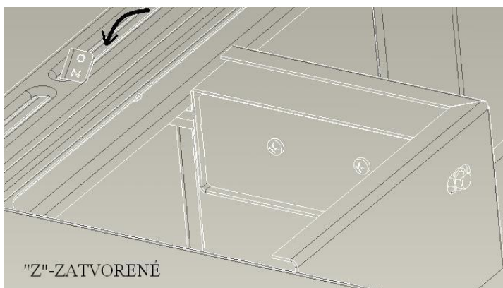
FIKO 70 Nostalgie B Rauchabzugsklappe ist geschlossen
